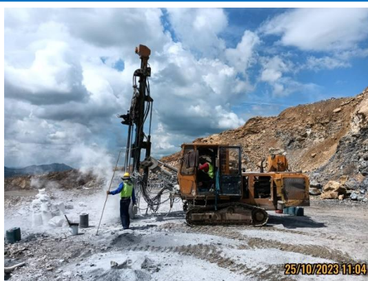
รูปที่ 3-5 เครื่องเจาะรูระเบิดที่มีอุปกรณ์เก็บฝุ่นติดไว้กับหัวเจาะ
